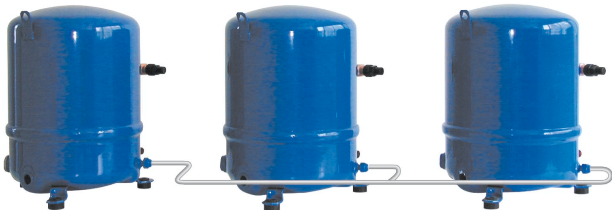
Rys 2.1 Przykład prawidłowo zamontowanej rurki wyrównawczej poziomu oleju. Wszystkie sprężarki są tej samej wielkości i wydajności i zamontowane są na tym samym poziomie.
